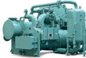
CYK HP Bomba de calor agua-agua Doble compresor centrífugo Disposición en serie / R1234ze Agua caliente hasta 93°C Capacidad calorífica: 4000 a 10000 kW
