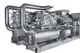
DualPAC recip 2 etapas Velocidad variable Compresor recíproco / R717 Agua caliente hasta 90°C Cap. calorífica: 400 a 2900 kW
