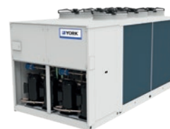
YHA Bomba calor aire-agua sistema 4 tubos Compr. Scroll / R410A Agua caliente hasta 60°C Capacidad calorífica: 22,2 a 463,7 kW
