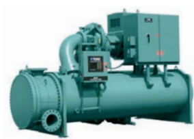
YK Bomba calor agua-agua Comp. centrífugo VSD / R1234ze Agua caliente hasta 68°C (Std) Agua caliente hasta 93°C (HP) Cap. calorífica: 1000 a 9000 kW
