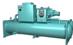
YVWH Bomba calor agua-agua Compr. tornillo VSD / R1234ze Agua caliente hasta 50°C Capacidad calorífica: 315 a 1250 kW
