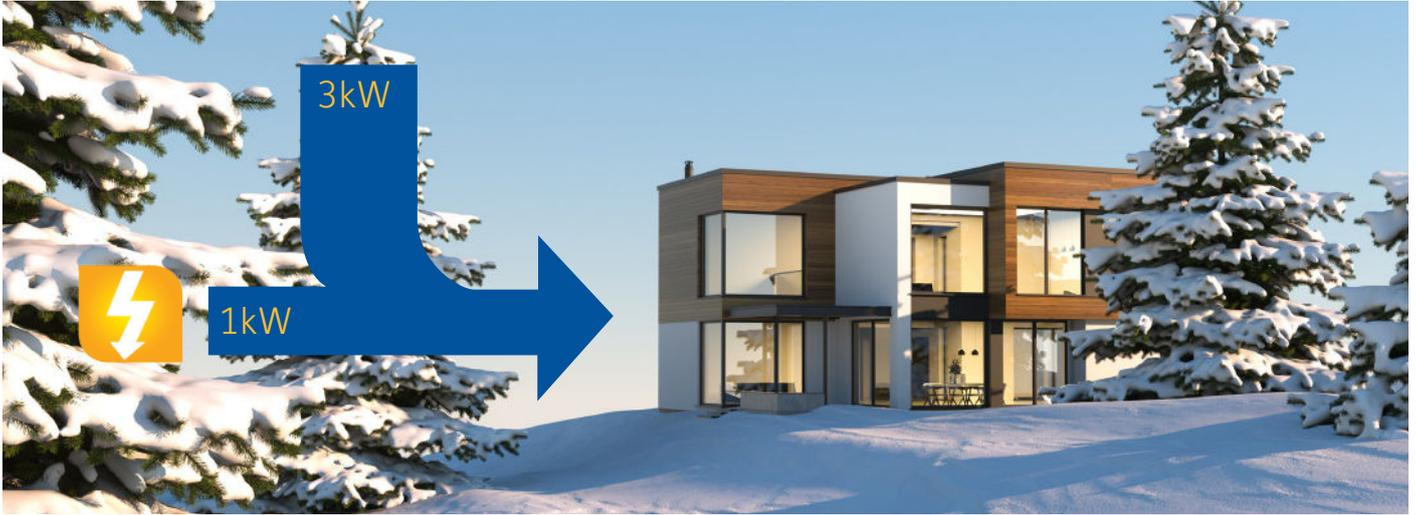
Por lo general, se pueden capturar alrededor de 3kWh de energía por cada 1kWh de energía eléctrica gastada, dando casi 4kWh de energía térmica por solo 1kWh de entrada eléctrica y proporcionando una eficiencia de casi el 400%.
