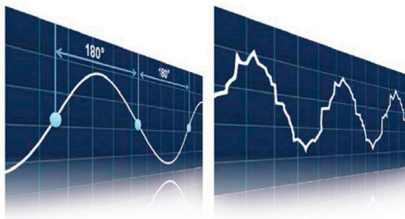
La onda sinusoidal suave mejora la eficiencia alrededor de un 30% en comparación con la onda de diente de sierra convencional
