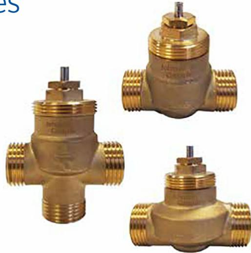
La serie de válvulas de latón VG3000 está diseñada principalmente para regular el flujo de agua en respuesta a la demanda de un controlador en aplicaciones de zona y de unidades terminales, como fan coils, cassettes, techos refrigerados y pequeños sistemas de calefacción/refrigeración. Las válvulas están disponibles con conexiones de 2 vías y mezcladoras de 3 vías con y sin by-pass, con diferentes tipos de roscas de válvula.
